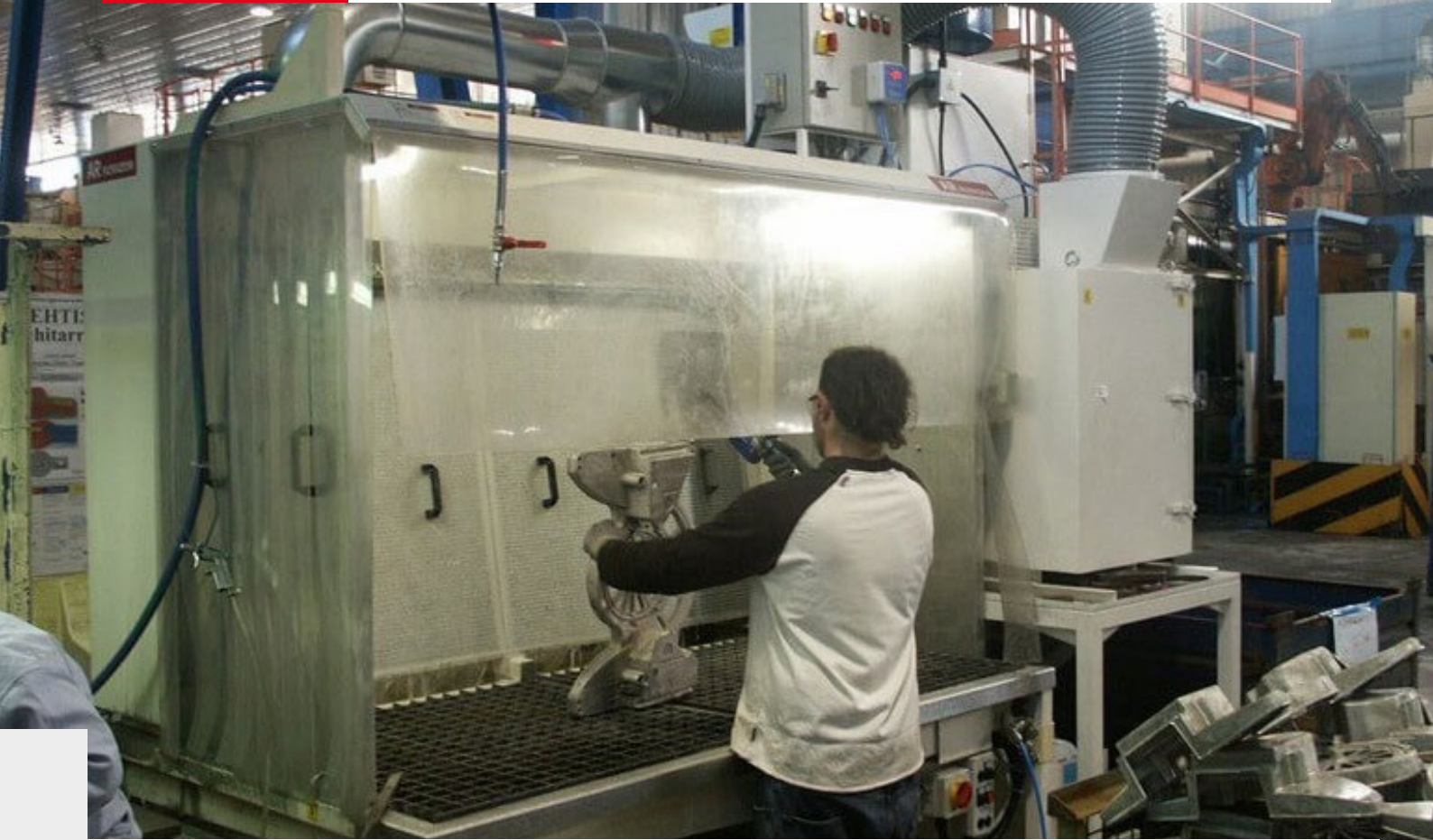
HYDROFILTER UND HYDRODESK FÜR MANUELLE TROCKEN-MAGNESIUM-ENTGRATEN-VERFAHREN
