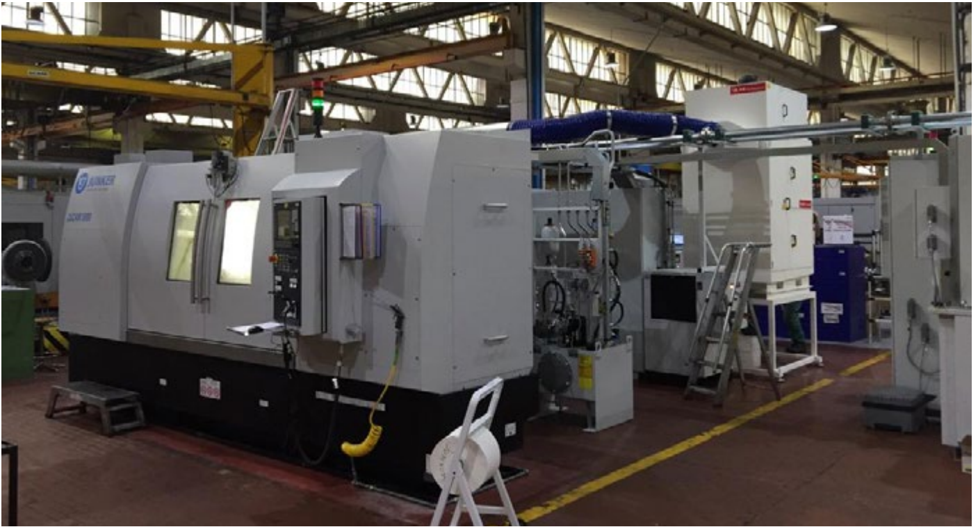
INSTALLATION eines COALFILTER auf einer SCHLEIFMASCHINE von JUNKER
