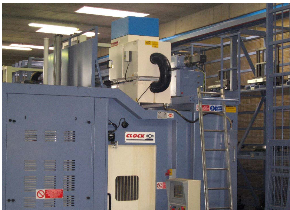
Beispiel für die Anwendung eines Serien-Luftreinigers "Arno VPF" in einem Produktionsbetrieb des Unternehmens Bettinelli S.p.A.
