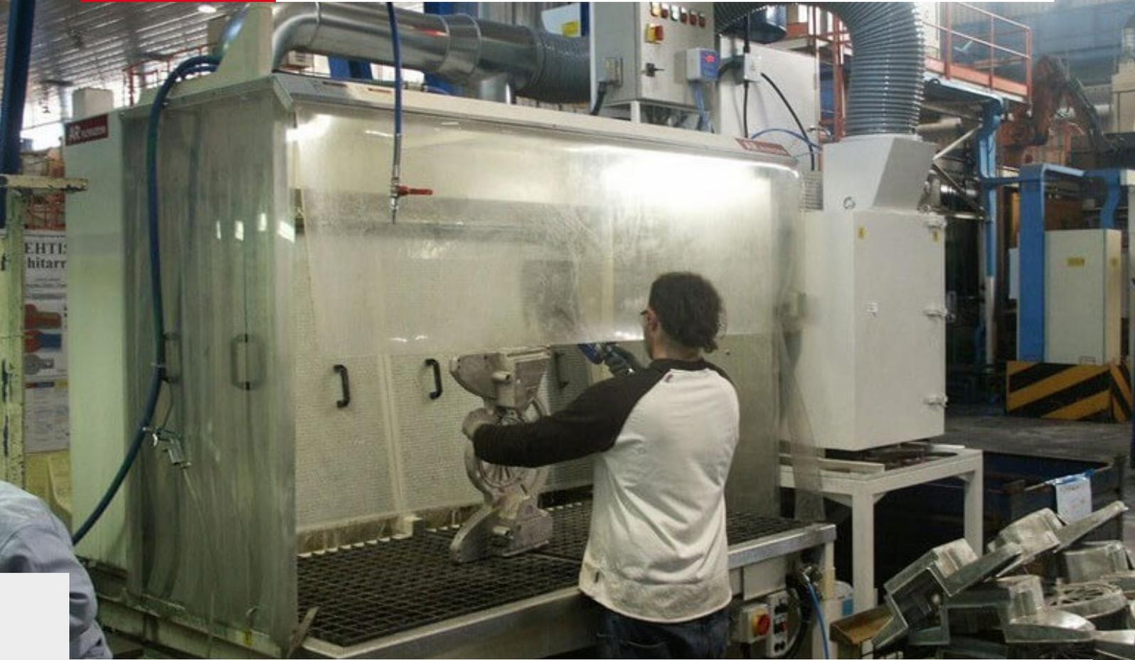
HYDROFILTER UND HYDRODESK FÜR MANUELLE TROCKEN-MAGNESIUM-ENTGRATEN-VERFAHREN
